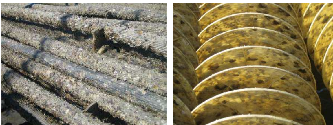
Photo 3 : Collecteurs témoins (tubes plastiques à gauche, coupelles plastiques à droite)
