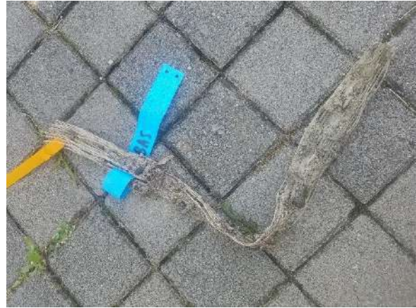
Figure 31 : échantillon de filet récupéré après 8 mois d'immersion en milieu marin
