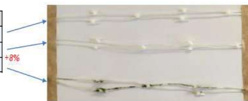
Figure 34 : Comparaison des échantillons pour l'allongement des mailles après utilisation (source : Seabird)
