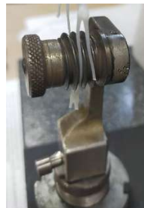
Figure 33 : Support pour nos filets lors des essais de traction
