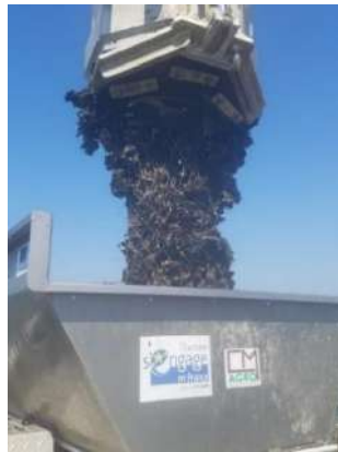
Figure 16 : La pêcheuse s'ouvre pour relarguer son contenu dans le dégrappeur.
