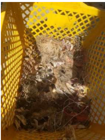
Figure 22 : déchets en sortie de chaîne de lavage
