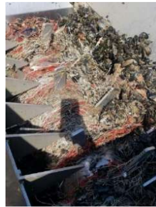
Figure 17 : Vue de l'intérieur du dégrappeur avec différents filets de catinage.
