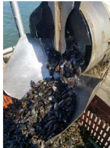
Figure 21 : Vue des moules en sortie de laveuse arrivant dans le géobox (caisse-palette)
