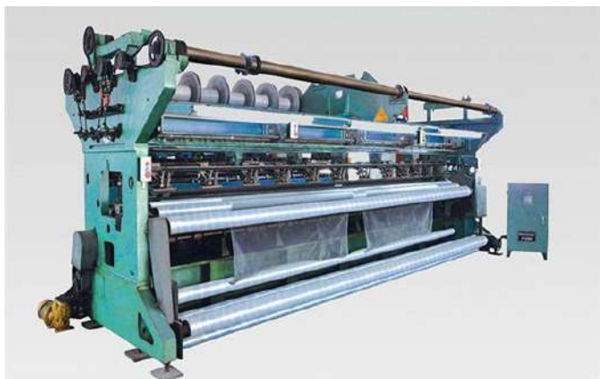
Figure 16 : Machine Raschel pour le tricot en chaîne
