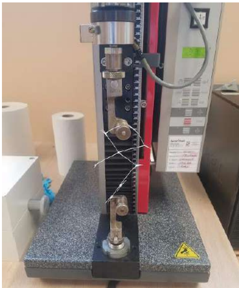
Figure 28 : Vue de la machine de traction (traction radiale en X).
