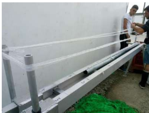
Figure 7 : Préparation des longueurs de filets à l'aide d'un banc de mesure
