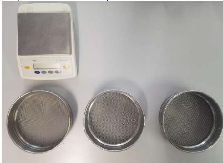
Figure 38 : Vue de la balance et des tamis utilisés pour cette expérimentation, de gauche à droite : 1mm, 2mm, 5mm.
