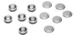
Figure 26 : Capsules et couvercles d'échantillons en aluminium utilisés pour la DSC
