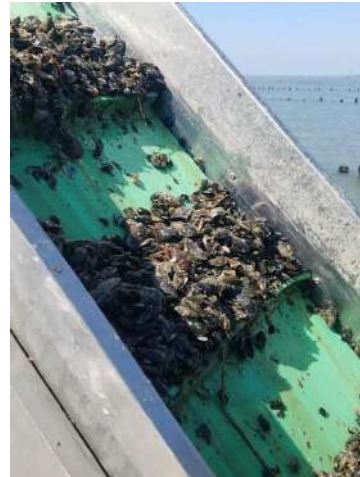
Figure 19 : Tapis roulant acheminant les moules jusqu'à la chaîne de lavage.
