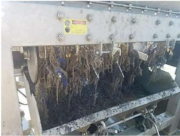
Figure 18 : Vue des filets pris dans les couteaux du dégrappeur (arrière de la machine).
