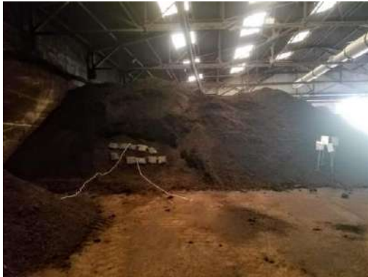
Figure 36 : Vue de l'andain et des dispositifs installées en chapelets
