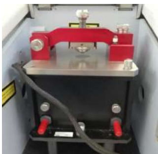
Figure 19 : Outil universel utilisé pour réaliser une analyse ATR
