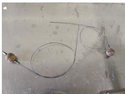
Figure 8 : tiges de déméduation (ou aiguilles ikejime) (pêcheur 1)
