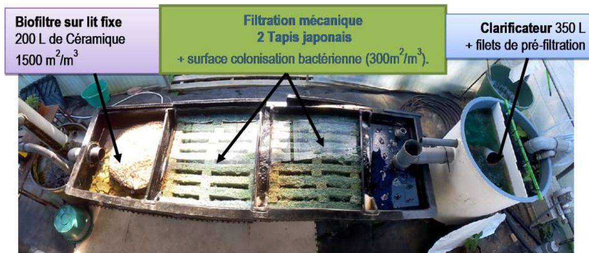
Figure 12 : photo du compartiment filtration (Laviale, 2015)
