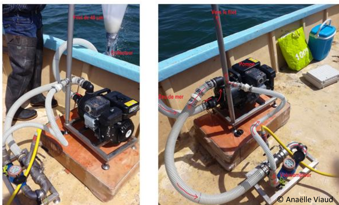
Figure 5 : Montage et matériels utilisés pour le prélèvement des échantillons d'eau de mer.
