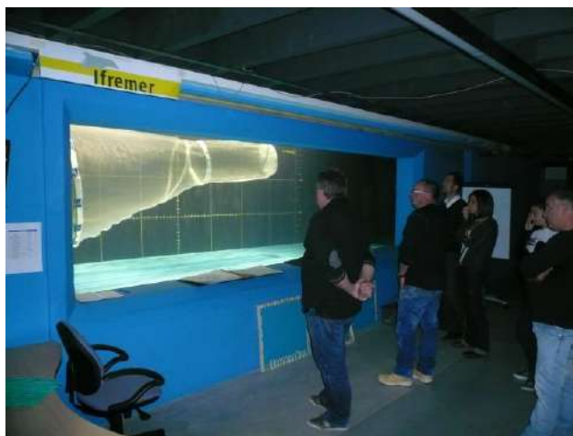
Figure 44 : Echanges entre professionnels, scientifiques et partenaires techniques devant un tamis immergé au bassin d'essais de l'Ifremer (Lorient, le 25 novembre 2014)
