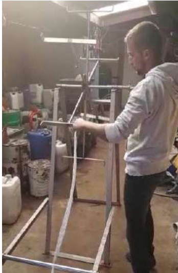
Figure 11: Outil tournant à manivelles permettant la mesure des longueurs de filet
