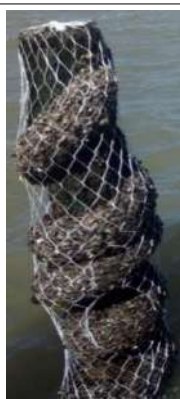
Figure 21: Filet Ecoplas endommagé, posé sur un pieu test, site de Banc du Nord le 18/09/2019
