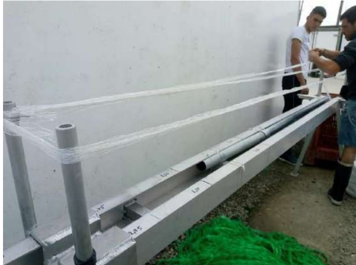
Figure 12: Banc de mesure des longueurs de filet
