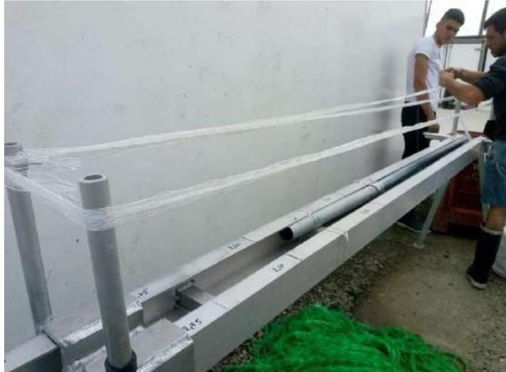
Figure 12: Banc de mesure des longueurs de filet
