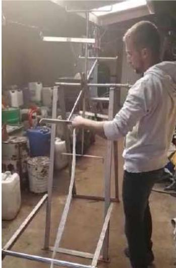
Figure 11: Outil tournant à manivelles permettant la mesure des longueurs de filet
