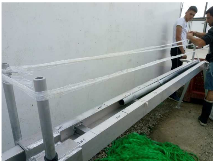
Figure 12: Banc de mesure des longueurs de filet
