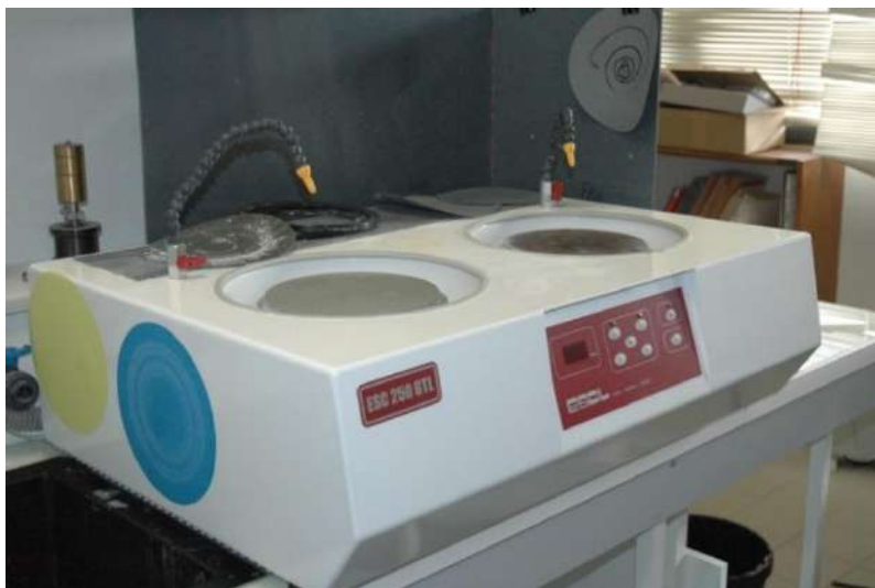
Ponceuse Escil ESC 250 GTL utilisée pour le ponçage des otolithes avec disques
